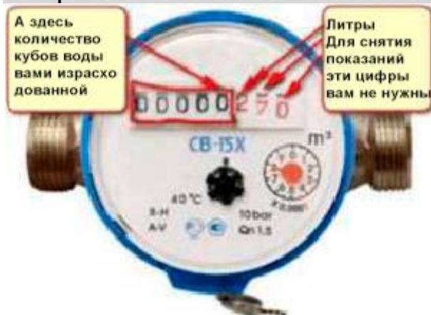
Большинство современных счетчиков воды имеют 8 разрядный счетный механизм как видно на картинке, на счетчике есть 8 цифр. Первые пять цифр черного цвета показывают кубические метры воды. Последние три цифры, как правило, выделенные красным цветом, обозначают десятые, сотые и тысячные доли кубического метра воды. Красные цифры — это литры, в данном случае 270 литров. Остаются следующие 5 цифр, вот по ним мы и будем снимать показания.
